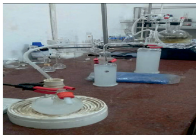
चित्र 3 ख.3 एरोबिक परिस्थितियों में जैव-अपघटन परीक्षण
